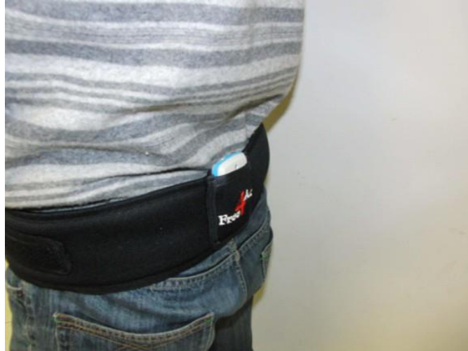
Figura 3, imagen donde se muestra la colocación del dispositivo BTS G-Walk®.
