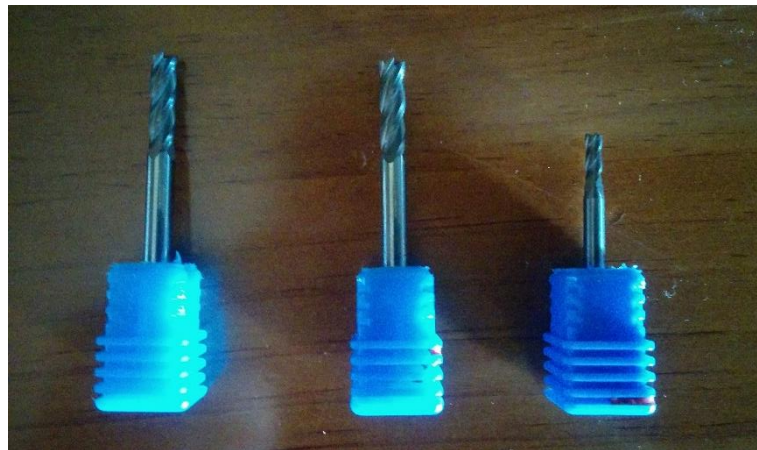
Imagen 12. Fresas empleadas para los ensayos.
