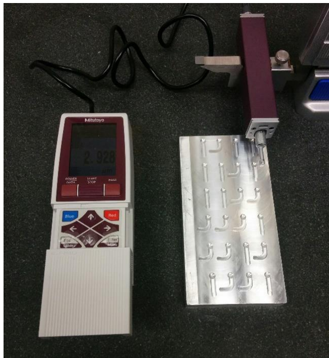
Imagen 8. Disposición del rugosímetro Mitutoyo SJ-210.
