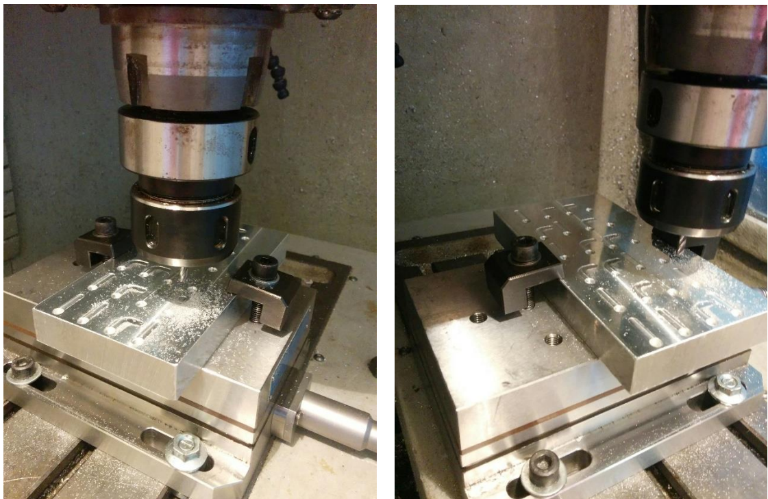
Imagen 25. Diferentes vistas del mecanizado en Odisea con fresa de 4 mm. Izquierda: vista desde esquina delantera. Derecha: vista desde esquina trasera.
