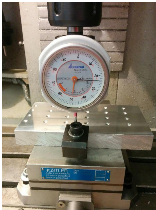
Imagen 23. Vista frontal de la medida de la horizontalidad transversal de la pieza pequeña, posición final.
