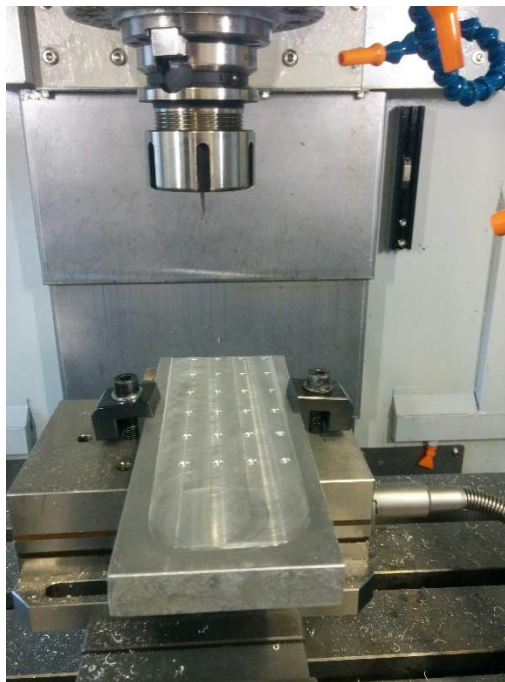
Imagen 28. Disposición de la pieza en fresadora Lagun L650 para mecanizado con fresa de 2,5 mm de diámetro.
