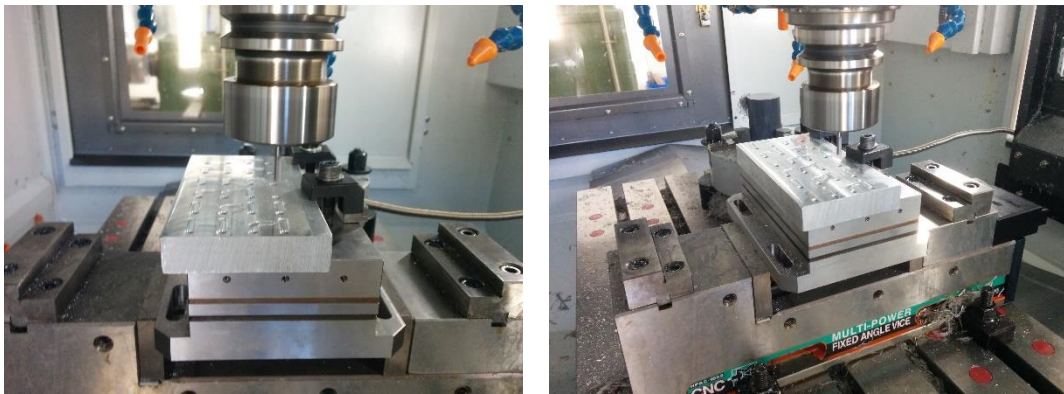
Imagen 27. Mecanizado realizado en Lagun L650 con fresa de 4 mm.
