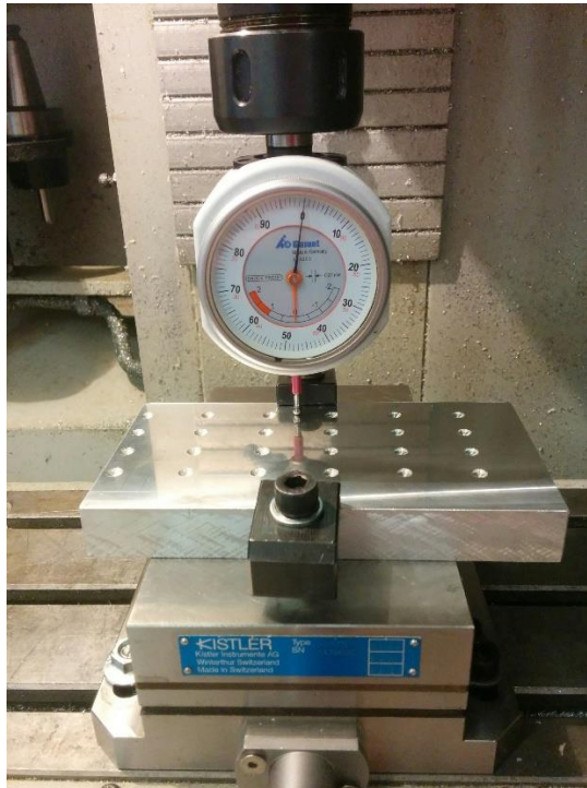
Imagen 22. Vista frontal de la medida de la horizontalidad transversal de la pieza pequeña, posición inicial.
