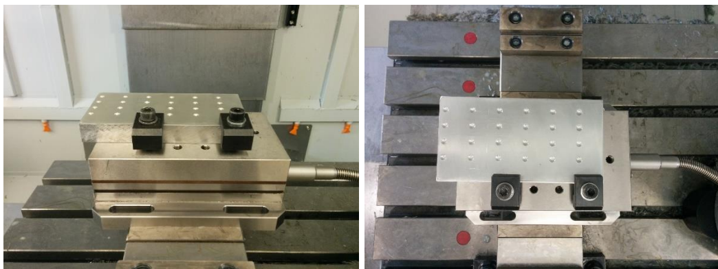
Imagen 20. Disposición de experimentos en Lagun L650 para fresa de 4 mm de diámetro. Izquierda: vista frontal. Derecha: vista cenital.
